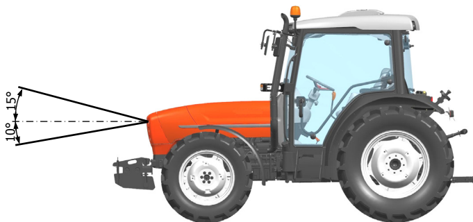
Fig. 16. Angoli verticali dei proiettori anabbaglianti
