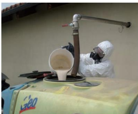
Corretta modalità di travaso del prodotto nell'atomizzatore
